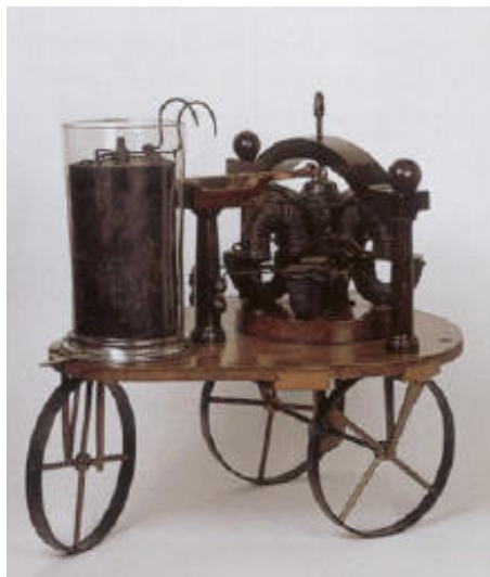
Fig. 2. Coche eléctrico construido por el profesor Stratingh
